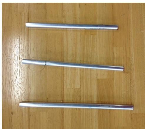
図4 パイプ長の調整と穴開け加工
